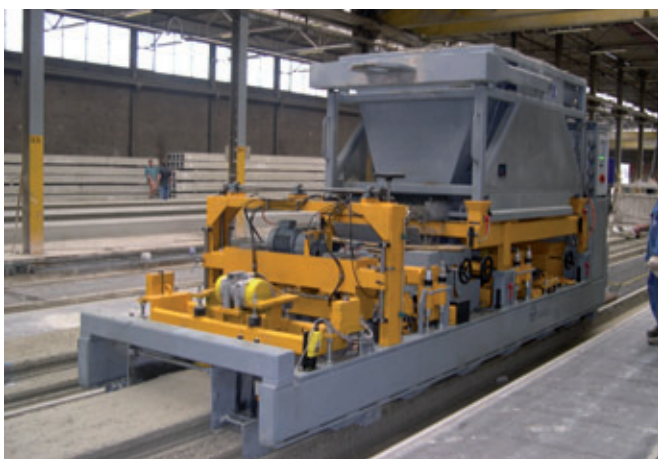
Abb. 1: Van de Weert-Deckenfertigungsmaschine. Die Wing Floor-Spannbetonfertigdecken weisen eine Breite von 1.200 mm auf und können daher auf Standard-Produktionsbahnen produziert werden
