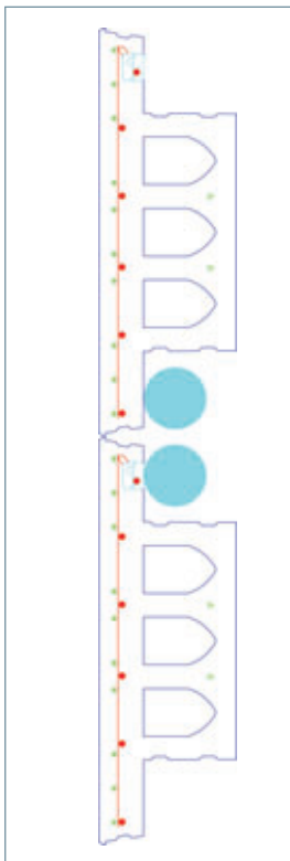
Abb. 4: Wing Floor-Spannbetonfertigdecken mit Frischluft- und anderen Versorgungsleitungen
